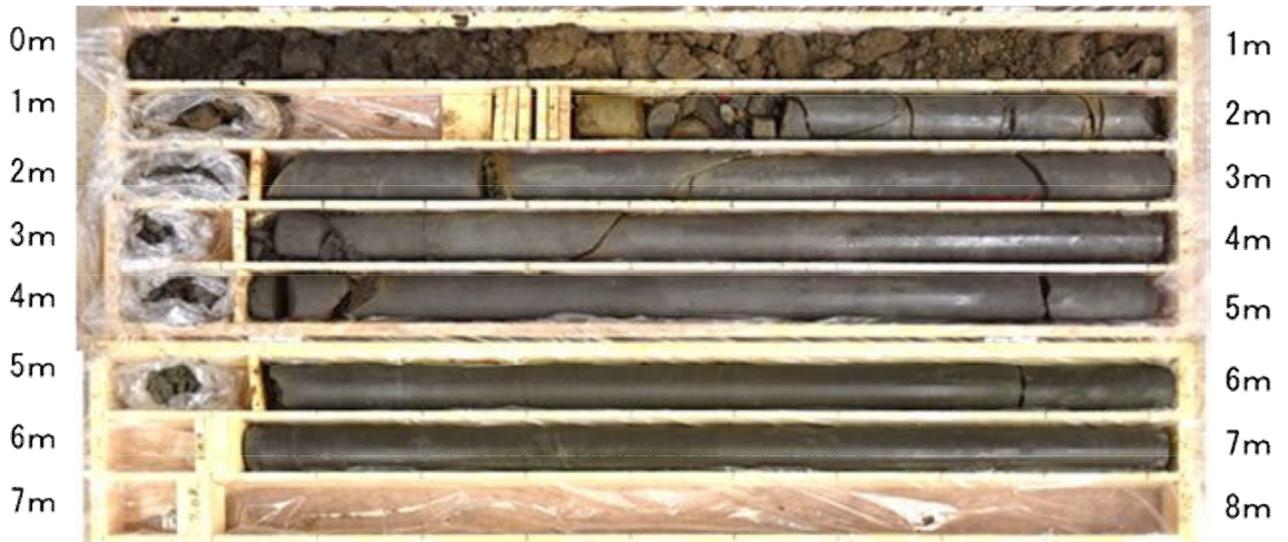
図 6.1.4 ボーリング柱状図及びコア写真 (R01-B-2)
