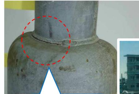
照明灯の溶接部に亀裂が生じており、放置すると破断して照明灯が転倒する可能性が高い状態
