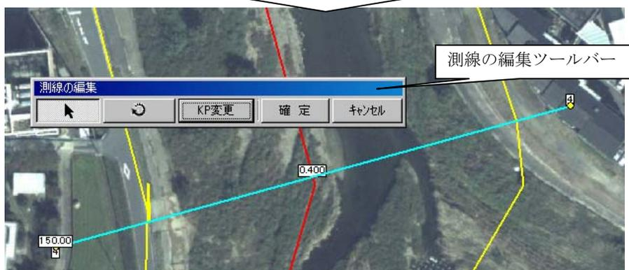
横断測線の編集は、①測線幅変更、②回転、③KP 移動が行える。
