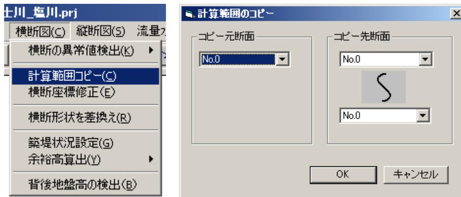
コピー元断面、コピー先断面を設定してOKボタンを押すと計算範囲がコピーされる。
