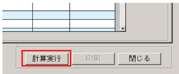
“計算実行” ボタンを押して、水位計算を実行する。
