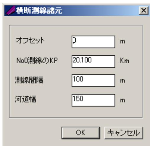
オフセット : 河心線の起点から横断測線の起点までのオフセット距離 (m)
