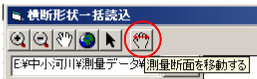
断面図上でマウスを左右にドラッグすると、既存断面形状が L 軸に沿って平行移動する。
