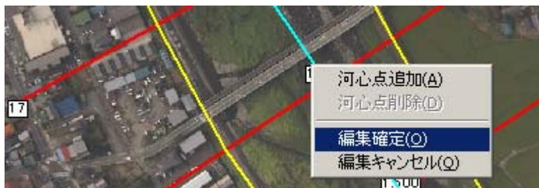
下図のアラートが表示され、編集確定前に河心線及び横断面情報のバックアップをとることを選択できる。
