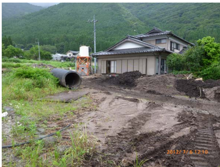
写真 8 県道 216 号から上流部にある家屋。大きな流木は確認できなかった、1m程度の巨礫がひとつ確認できたが、主要な粒径は数 10cm 程度であった。
