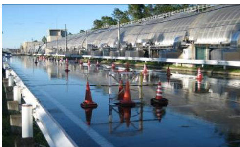
図2 実験コース(水膜路面 水膜厚:0.5~1.0mm)
