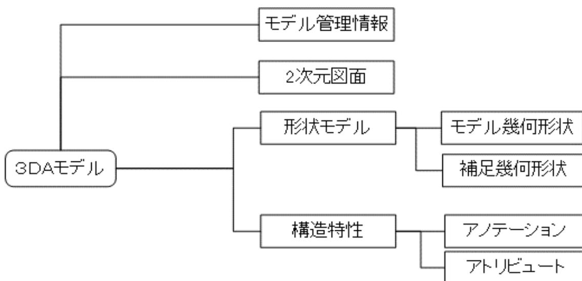
図 4-1 3DA モデルの情報構成
