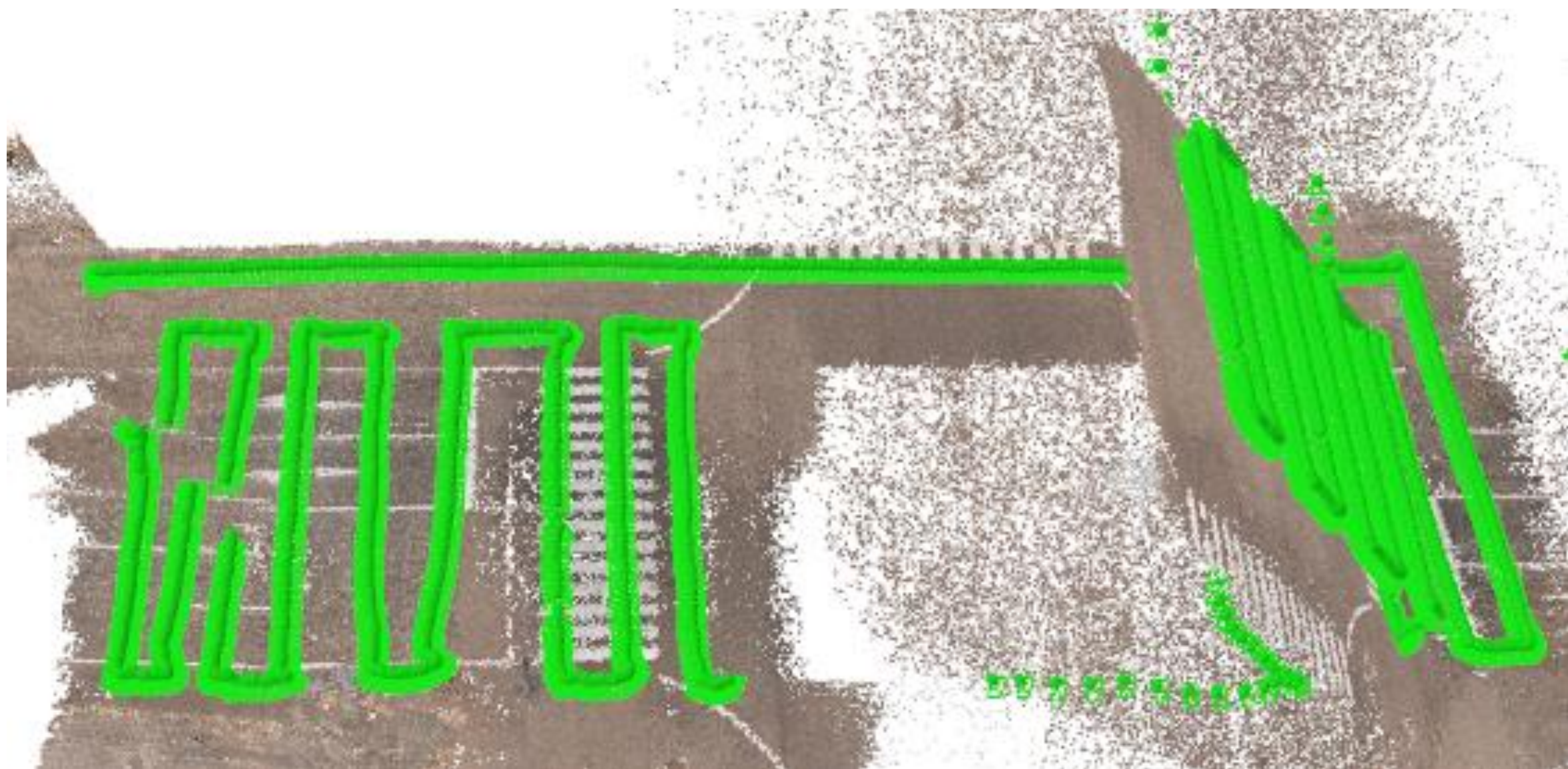
ウェアラブルカメラ（GoPro）により取得した点群データ （斜め下（俯角-45度）に向け撮影した場合）
