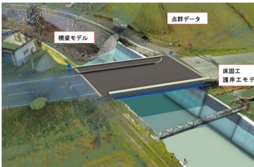
対象橋梁のほか、周辺の床固郡計画構造物を含めた完成系モデルを作成。
