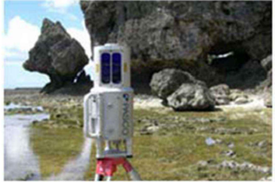
地上レーザ測量の様子
