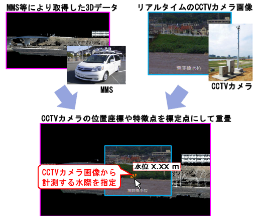
図-3 3Dデータと CCTV カメラ画像の重畳による水位計測例
