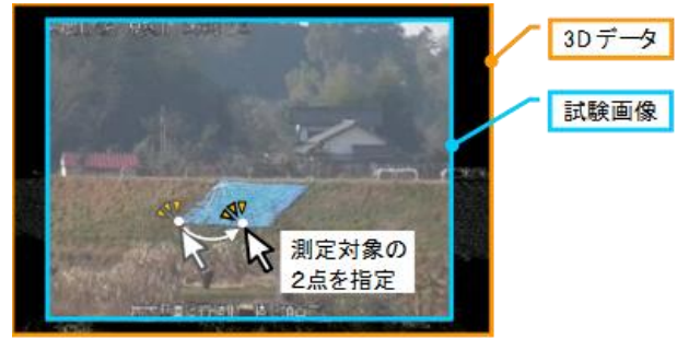
図-2 画像計測システムの計測方法
