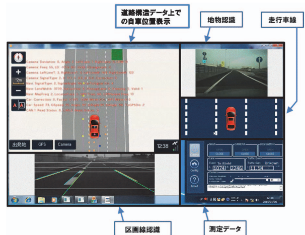
図 - 4 自車位置推定の走行実験のシステムイメージ
