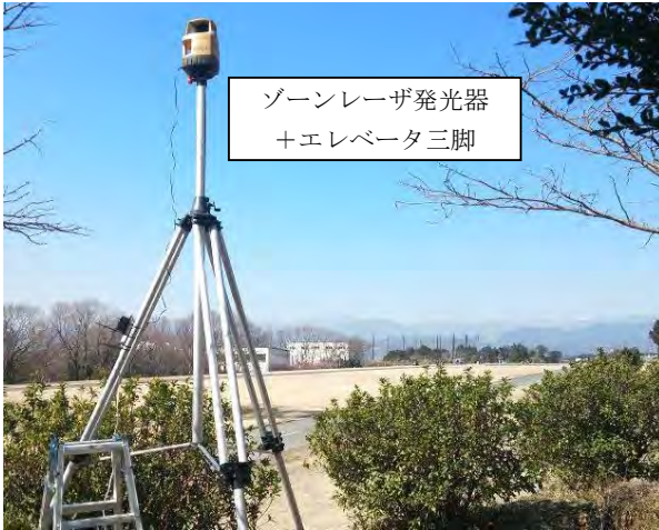
写真-1 ゾーンレーザ発光器設置状況
