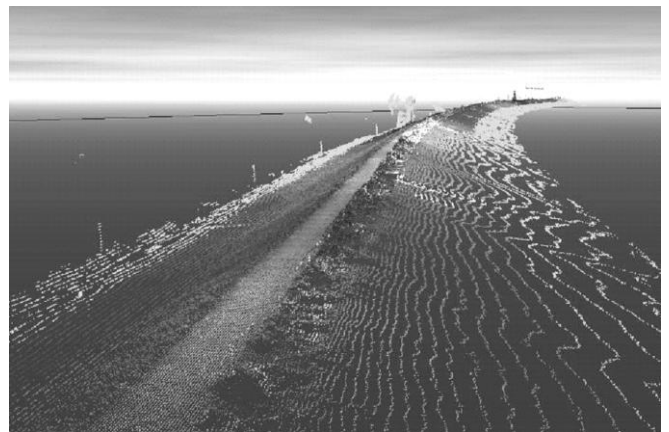
図-12 MMS 点群座標データの可視化結果 (G-Viz Lite1.0 三菱電機社)
