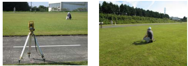
図-4 計測点設置状況
