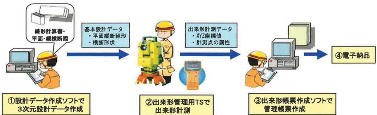
図-3 TSによる出来形管理の流れ
