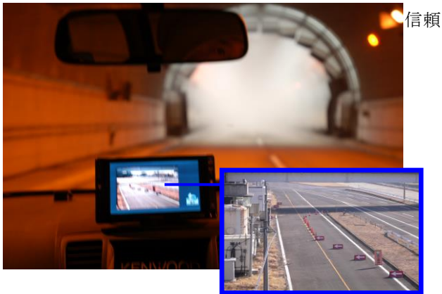
写真-1 静止画の蓄積再生による情報提供 (トンネル出口先の車線規制情報)
