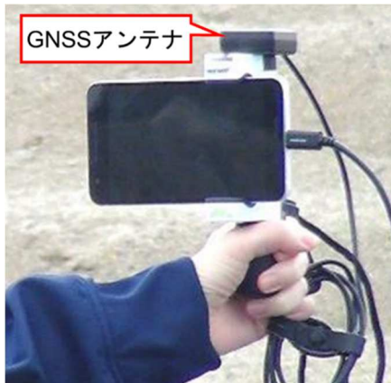
図-2 GNSS アンテナを取り付けた撮影用スマートフォン
