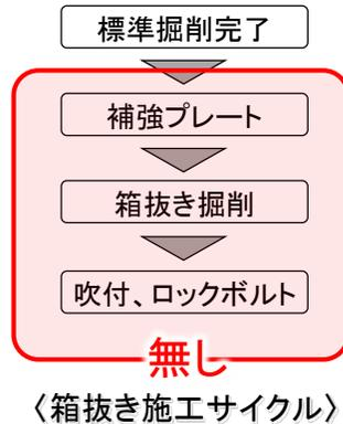
拡幅鋼製支保工の採用により、平日作業に影響がないよう土曜日に施工していた掘削後の箱抜き部の掘削補強が不要となり、平日の作業と並行した実施し土曜日作業を減。
