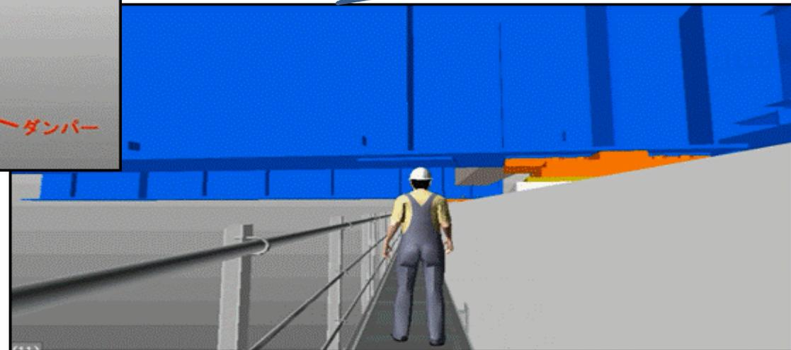
設計段階から、将来維持管理において制震ダンパー等の橋梁付属物が設置されることを踏まえた点検作業や点検動線の可視化、補修作業のイメージが可能
