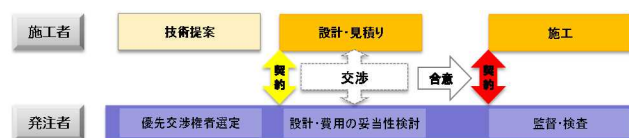
図-3 設計交渉・施工タイプのフロー
