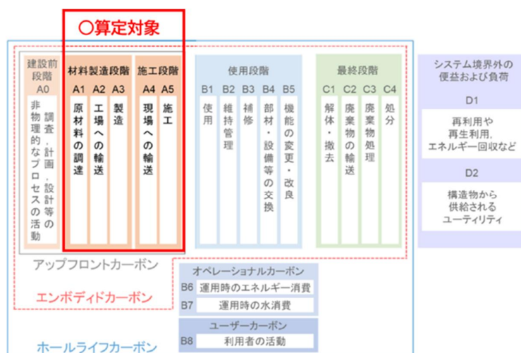
図－1 本マニュアルの算定対象範囲は「材料製造段階」「施工段階」である
