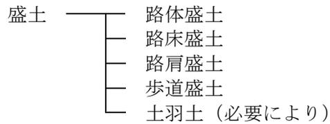
※ 土羽土  $V(\text{m}^3) = A(\text{m}^2) \times 0.3(\text{m})$
