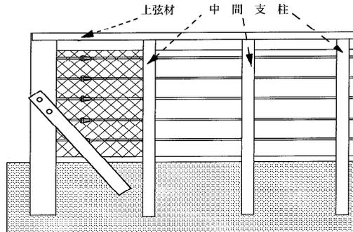
○落石防護柵 柵高の考え方
