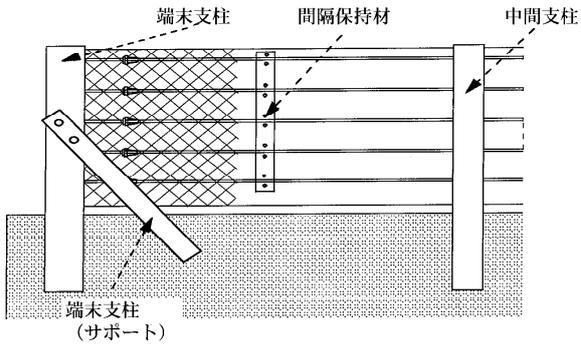
○耐雪型落石防護柵（上弦材付き）3.0m間隔
