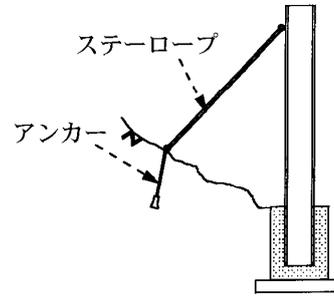
○耐雪型落石防護柵（上弦材付き）2.0m間隔
