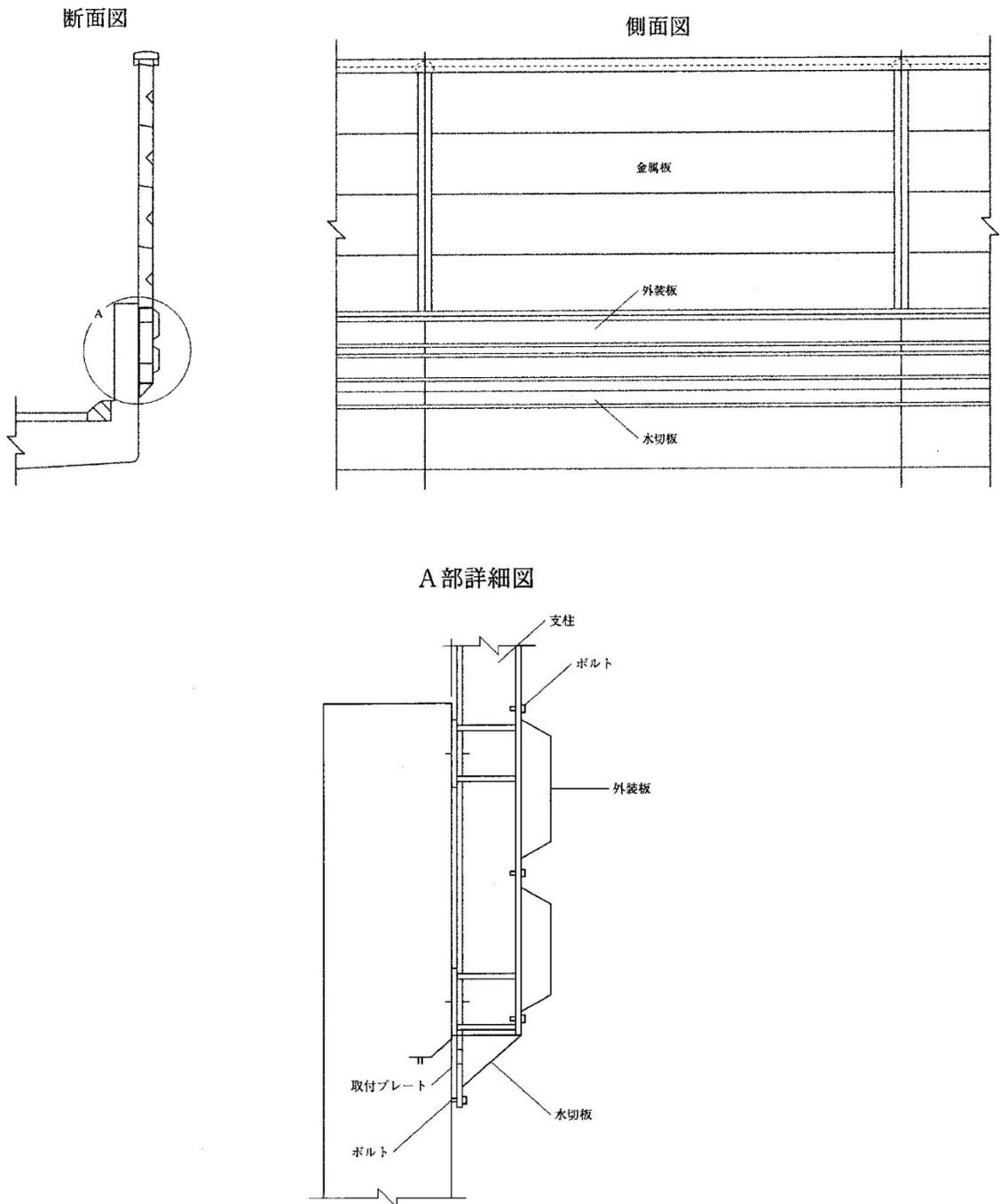
※水切板の設置高さは、施工基面からとする。
