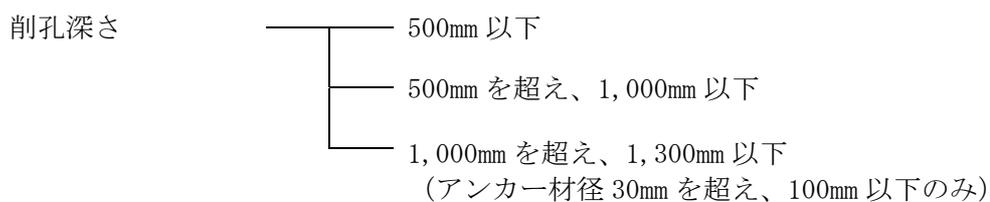
(4) コンクリート削孔 (さく岩機 (ハンドハンマ)) の削孔深さによる区分は、以下のとおりとする。
