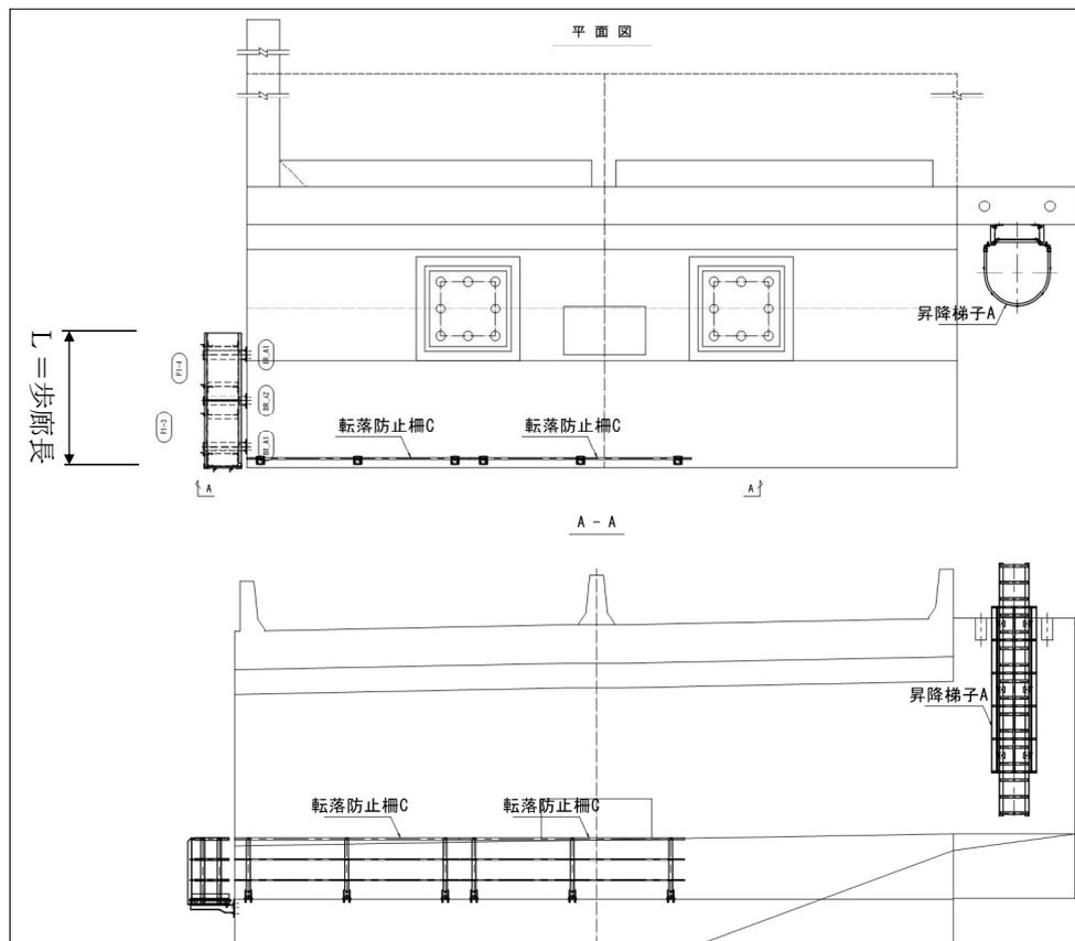
※転落防止柵は、橋梁検査路架設工に含まれないため、別途算出すること。
