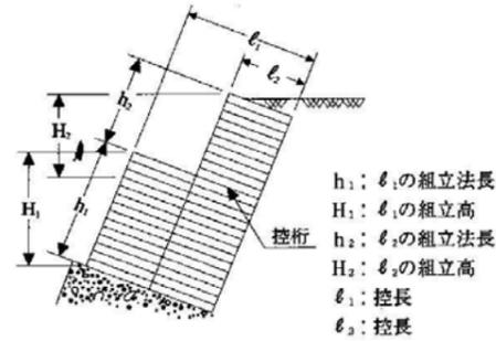
1) 鉄筋による組立式井桁ブロック平面図
