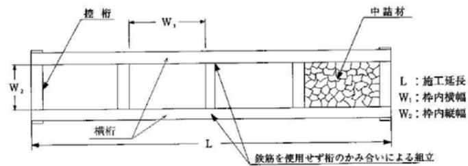
井桁ブロックの施工面積は、次式による。
