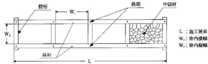
2) 組合せ式井桁ブロック平面図
