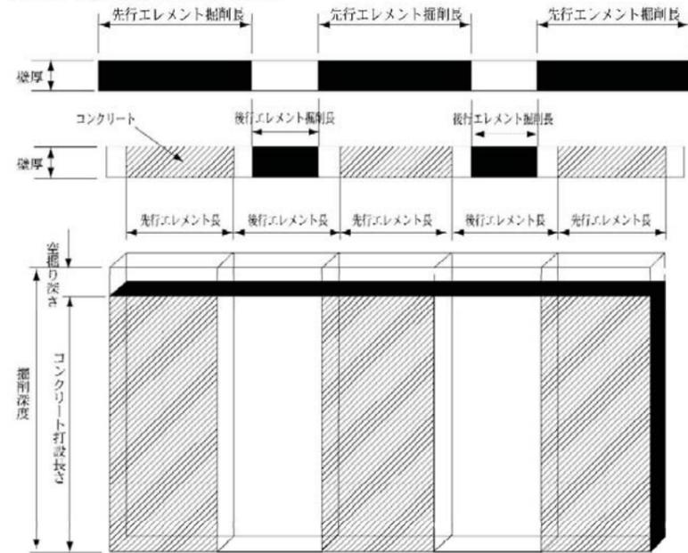
施工図 (コンクリートカッティング継手方式の場合)
