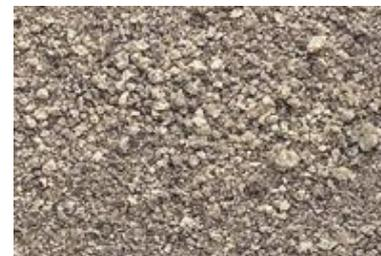
溶融状態から、一気に水冷却して製造され
