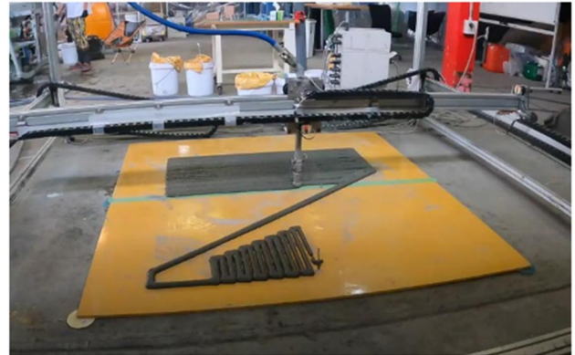
図-4.6 重力式擁壁 (プリント状況)
