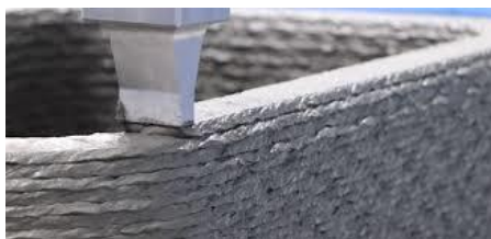
図-2.3 材料押出方式 (写真提供: 清水建設)
