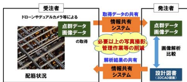
図-1 鉄筋組み立て時の新たな確認方法のイメージ
