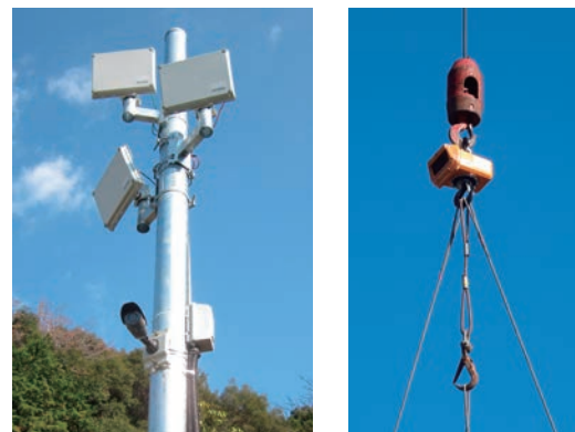
写真-7 ロケーターとカメラ(左)、クレーンスケール(右)
