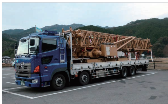
写真-3 10tトラックによる基部の運搬状況
