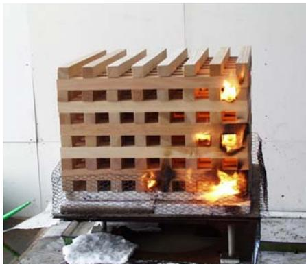
写真 2.4.1 自由空間における木材クリブの燃焼実験概要
