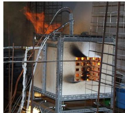
写真 2.4.2 区画内における木材クリブの燃焼実験概要 (天井有)
