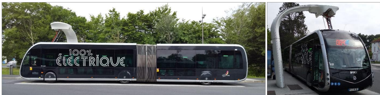
100%電気による連節バス、主要バス停の急速充電設備によりバス停で充電可能（バイヨンヌ：Irizar 社「lie tram」）
