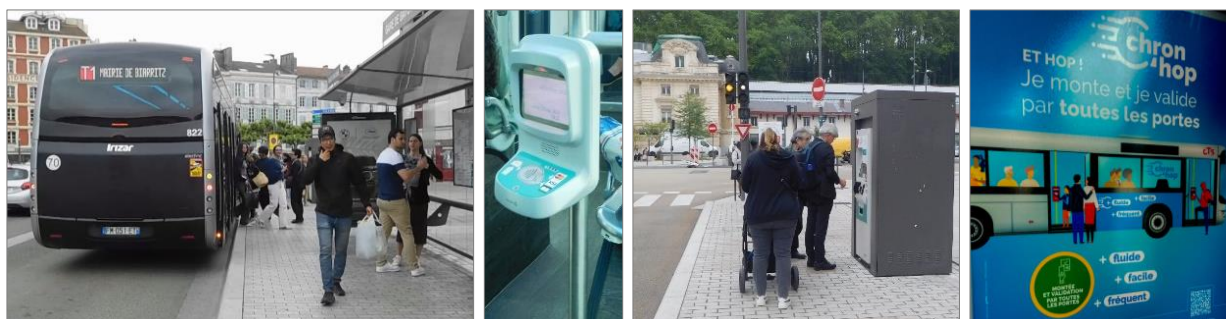
①信用乗車方式による連節バス全扉乗降車内の各扉に複数台設置された非接触式カード読み取り機／バス停留所に設置された事前購入用券売機（バイヨンヌ）
