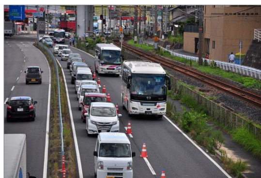
図 1-8 災害時BRTの運行の様子 バス・災害関係車両等専用レーン (国道 31 号 JR 坂駅南～水尻：約 1.3km) 出典 呉工業高等専門学校 神田研究室HPより
