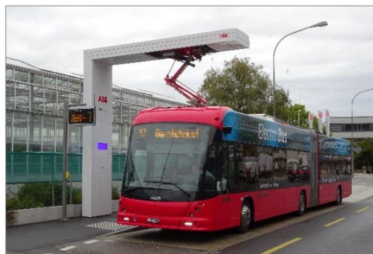
①100%電気による連節バス(全長約18m)、急速充電設備によりバス停で充電可能（左：バイヨンヌ／右：ベルン）
