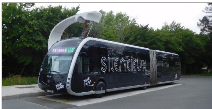
①100%電気による連節バス(全長約18m)、急速充電設備によりバス停で充電可能（左：バイヨンヌ／右：ベルン）
