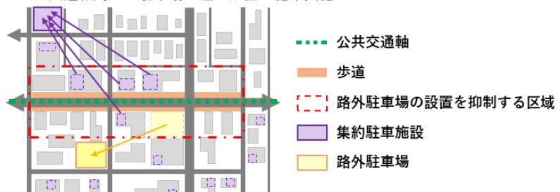
図 3-15 公共交通軸沿いの駐車施設の配置適正化施策のイメージ
