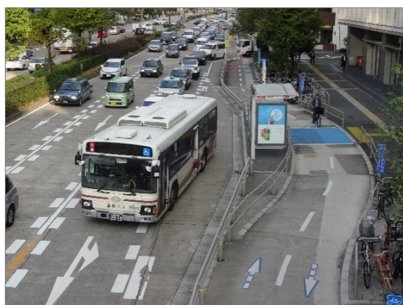
②⑩車道と自転車道との間に交通島のバス停留所を設けた例（名古屋市桜通：桜通大津バス停）
