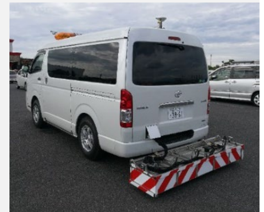
空洞化検査実施車両
