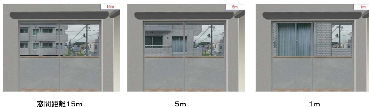
図13 戸建て住宅の2階居室から見た隣地のマンションの窓間距離の変化の様子
