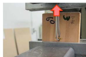
写真 2.5.4 基板面に平行の引張
