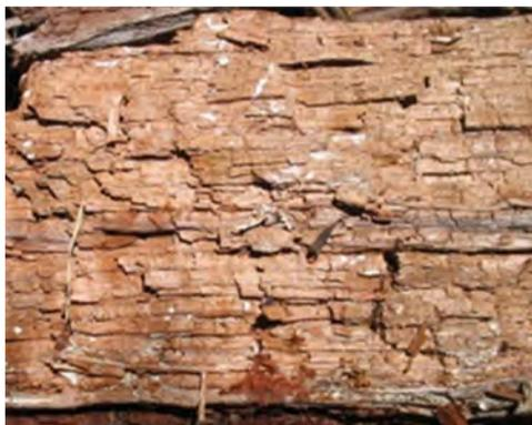
図 1.1.2 褐色腐朽材
