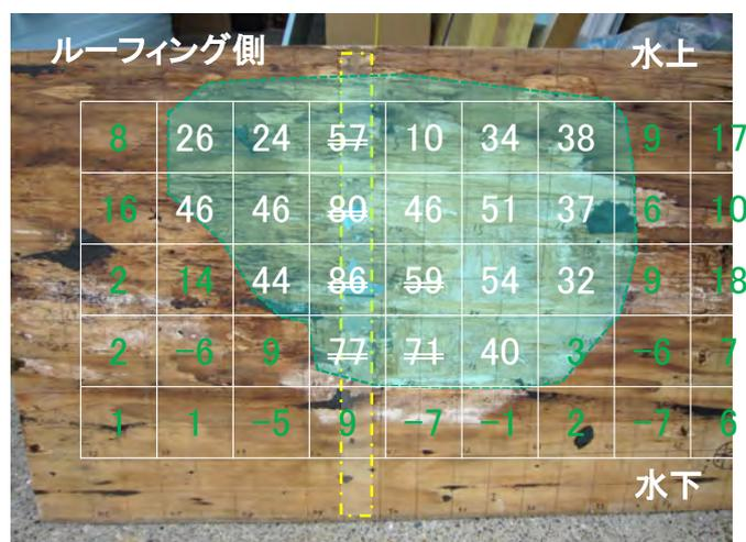
写真6.1.2 野地板の質量減少率(単位:%)
