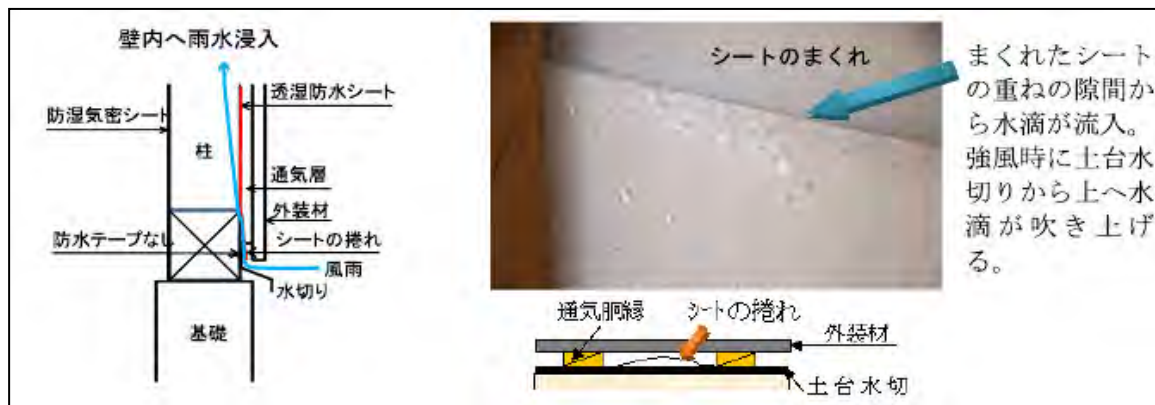
図 3.4.10 防水紙のたるみによる不具合（出典：国総研資料 第 779 号、20P）
