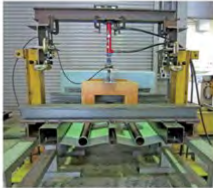
a. 鋼管を用いた線荷重載荷試験
