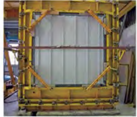
b. 圧力箱を用いた耐風圧性試験
