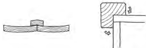
図 3.2.2 木の反りを見越した材の使い方 2)
