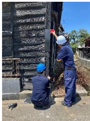
写真 6.2.10 残留変形 81/1000=1/12\text{rad}
