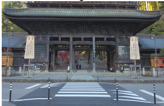
図-4 景観に配慮し色彩を黒系で統一したスムーズ横断歩道を設置した事例 (上:社会実験時、下:本設置時)
