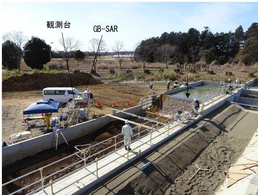
写真-4 越水実験状況
