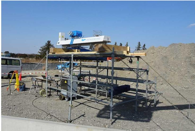
写真-5 河岸侵食実験における計測状況
