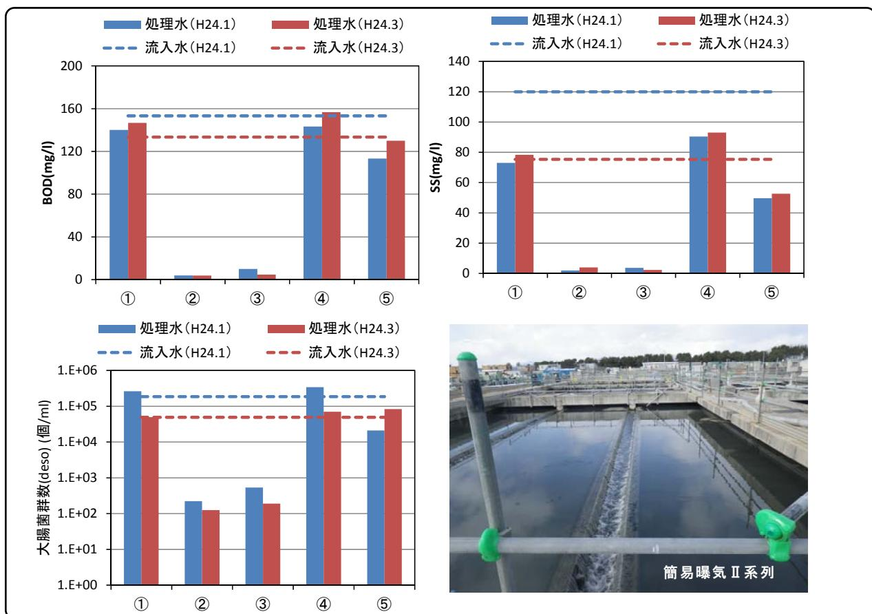
図 3.15 宮城県県南浄化センターの処理系列毎の水質分析結果
