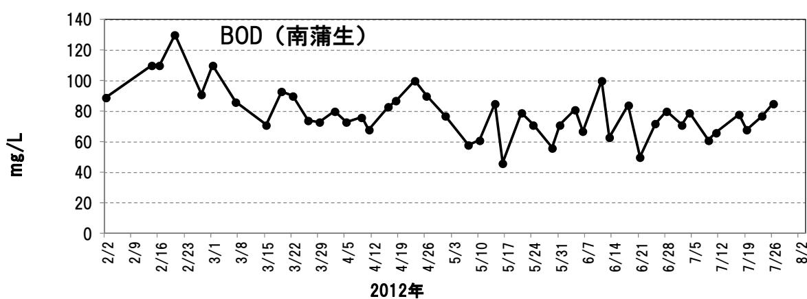
図 3.12 接触酸化法導入後の放流水 BOD の推移（仙台市南蒲生浄化センター）
