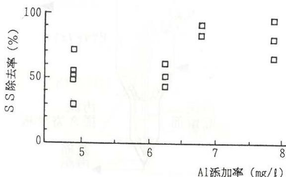
図 3.8 アルミニウム添加率と SS 除去率との関係(建設省総合技術開発プロジェクト「バイオテクノロジーを活用した新排水処理システムの開発」報告書平成 3 年 2 月より)
