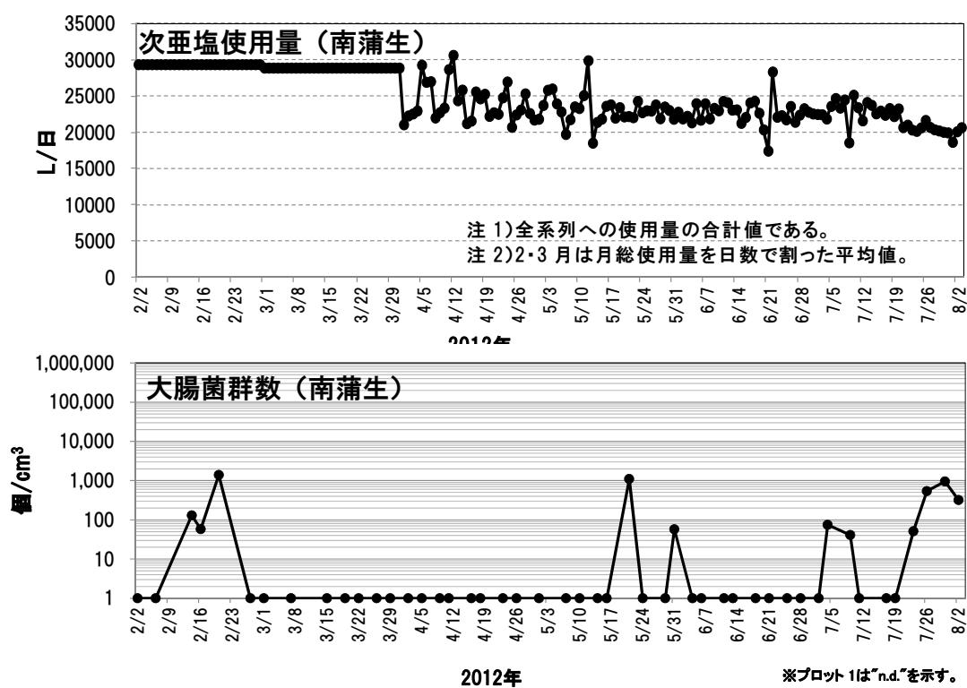
図3.20 塩素の添加量と処理水（接触酸化法＋塩素消毒）の大腸菌群数の関係
