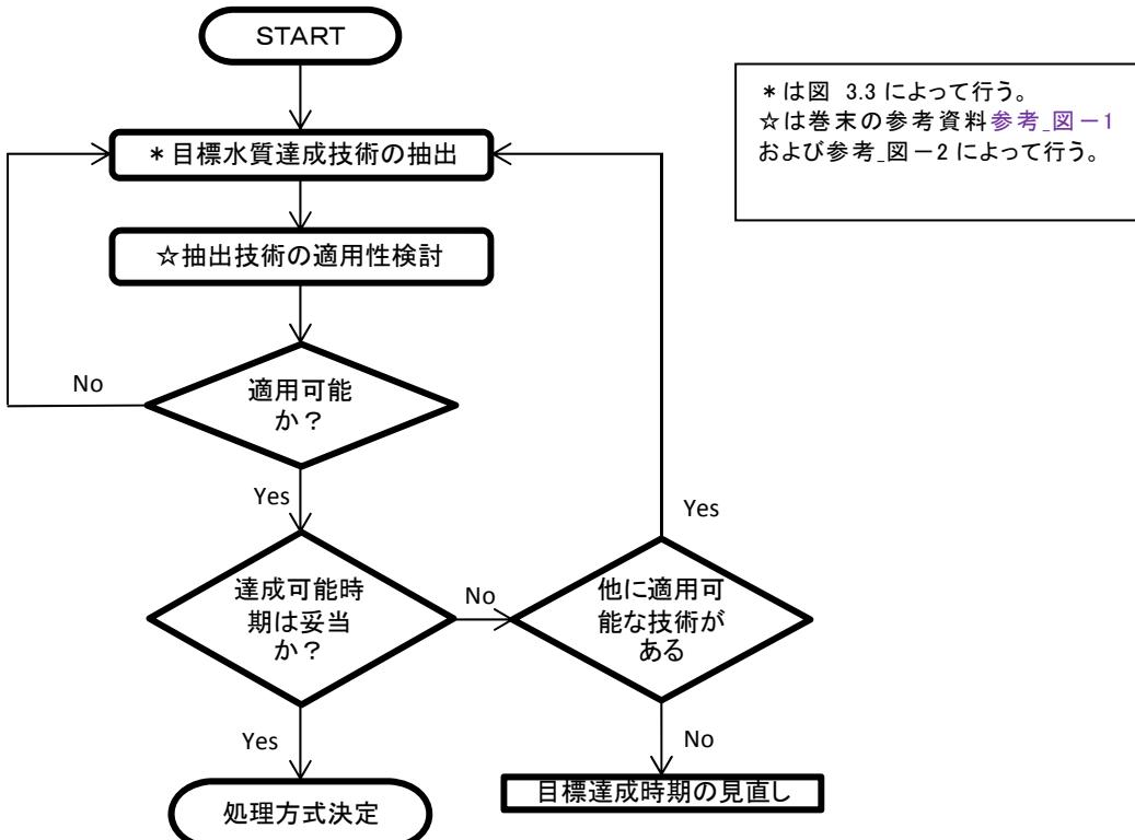
図 3.2 処理方式の選定フロー
