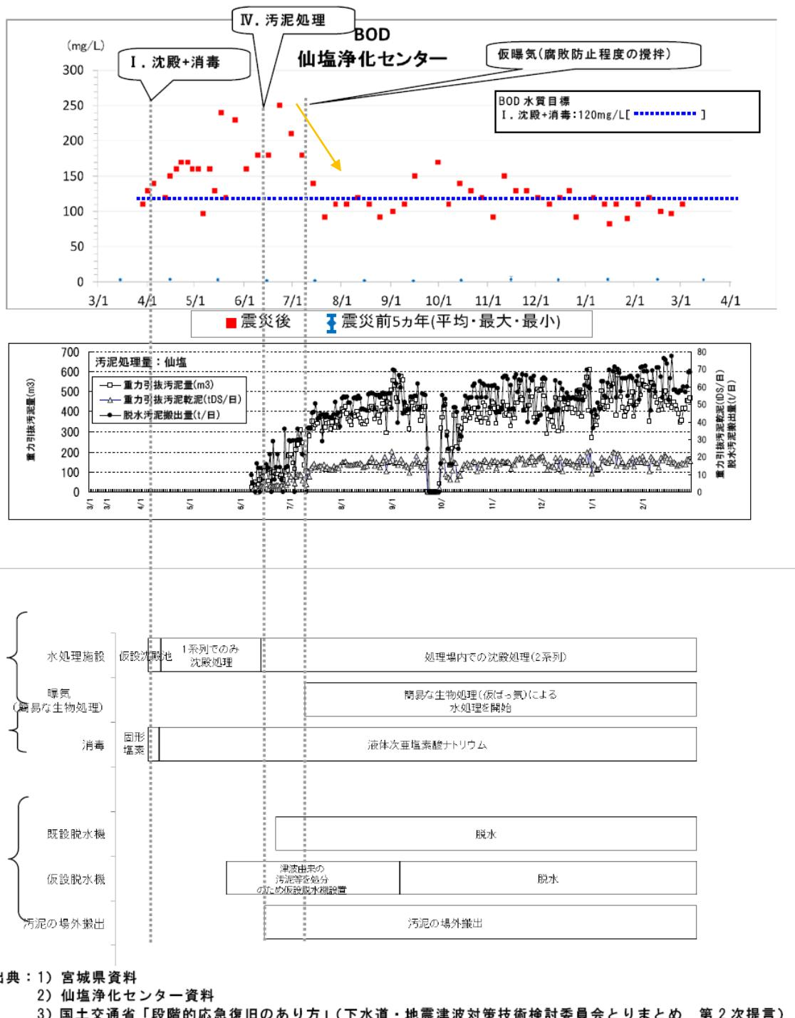
図 3.10 震災後の段階的処理と放流水水質 (BOD) との関係 (宮城県仙塩浄化センター)
