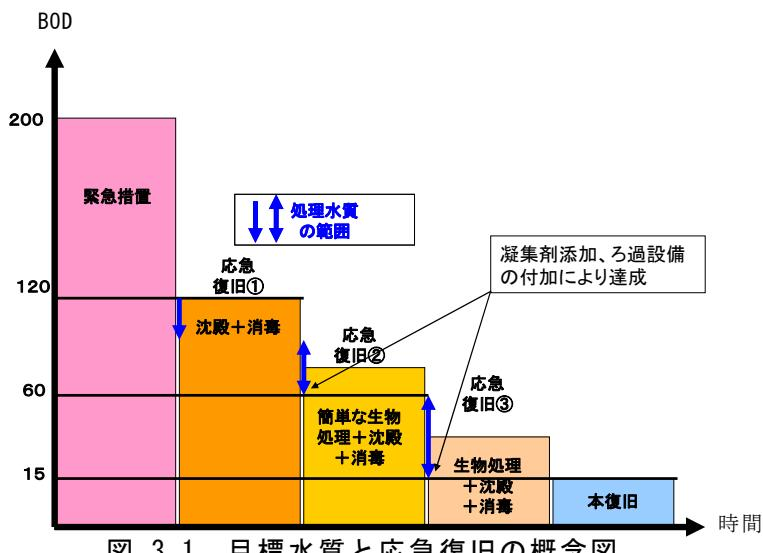
図 3.1 目標水質と応急復旧の概念図
