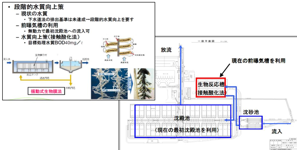
図 3.11 前曝気槽を活用した生物膜処理方式（接触酸化法：振動式生物膜法）
