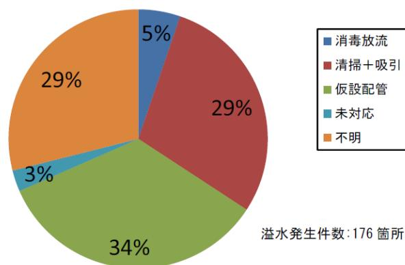
図 2.1 溢水発生時における対応状況（平成23年3月24日時点）
