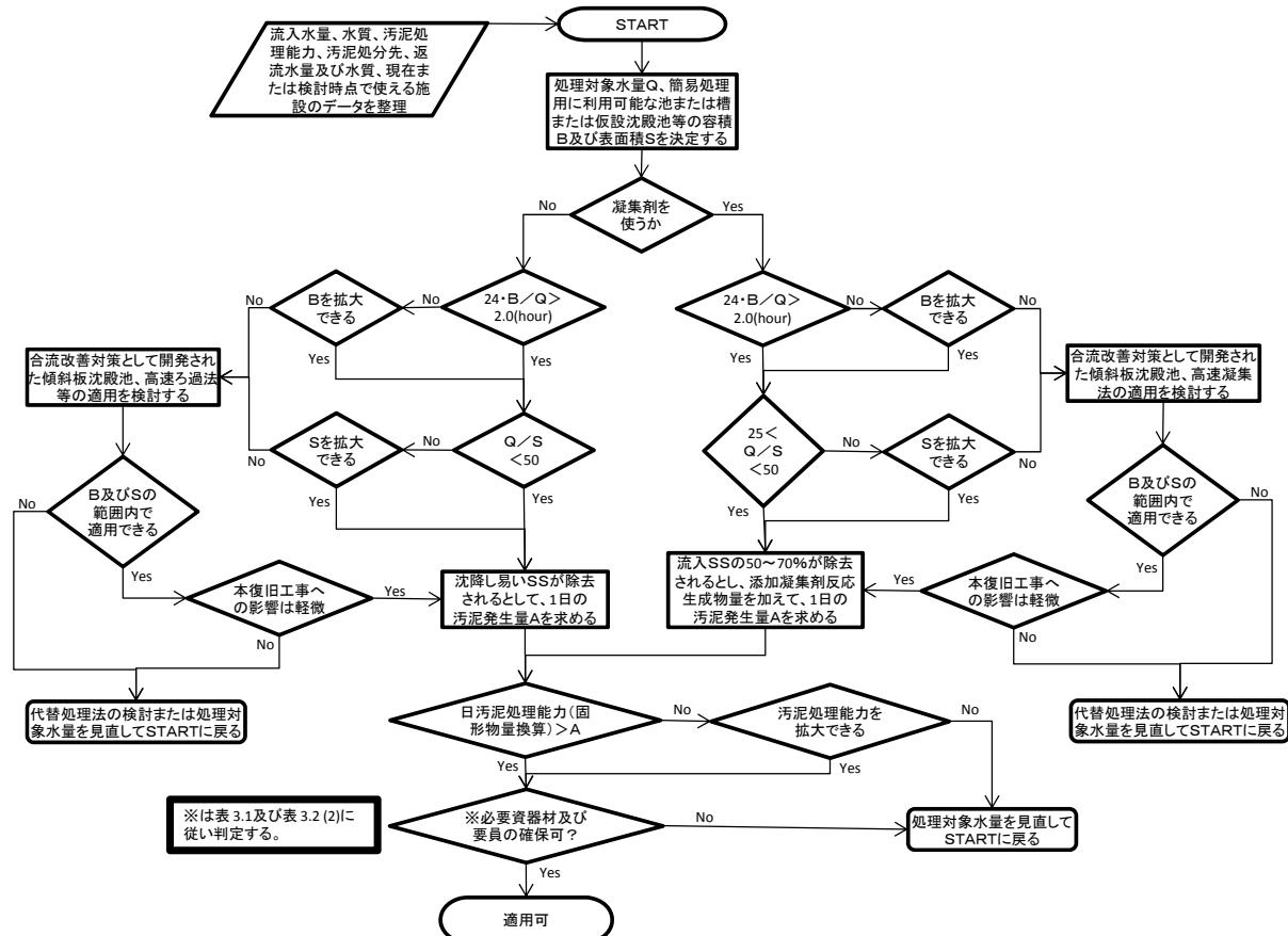
参考\_図-1 沈殿法・凝集沈殿法の検討
