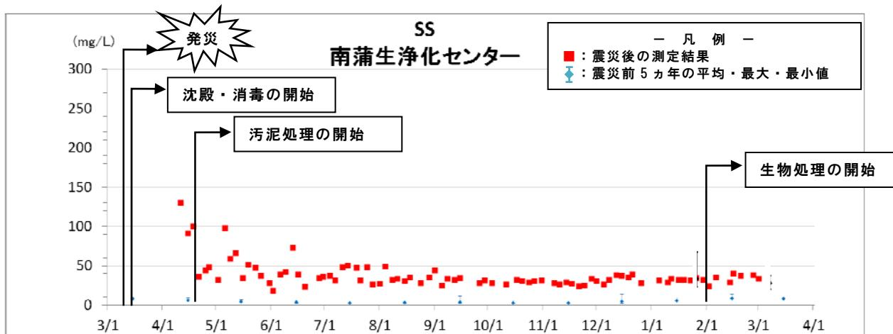
図 3.7 沈殿の開始と放流水の SS 濃度の関係（仙台市南蒲生浄化センター）
