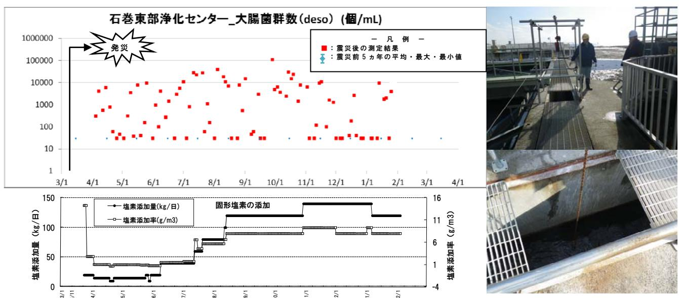
図 3.17 固形塩素による消毒の状況および水質の時系列変化
