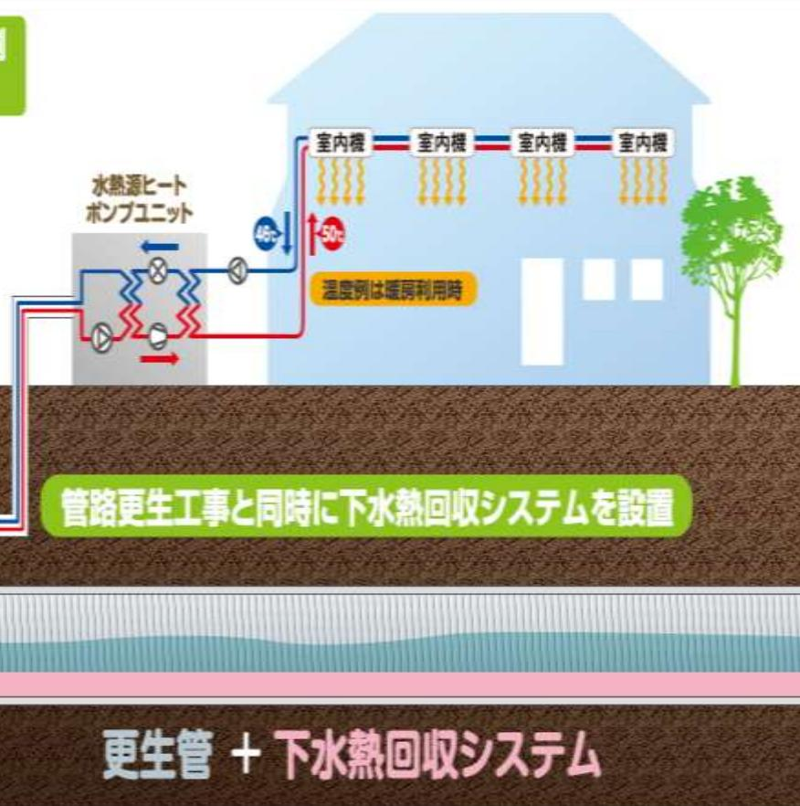
○一般的に、下水の温度には、冬季は外気温度より高く、夏季は外気温度より低いという特徴があるため、外気利用よりも高効率にヒートポンプ運転が可能。
