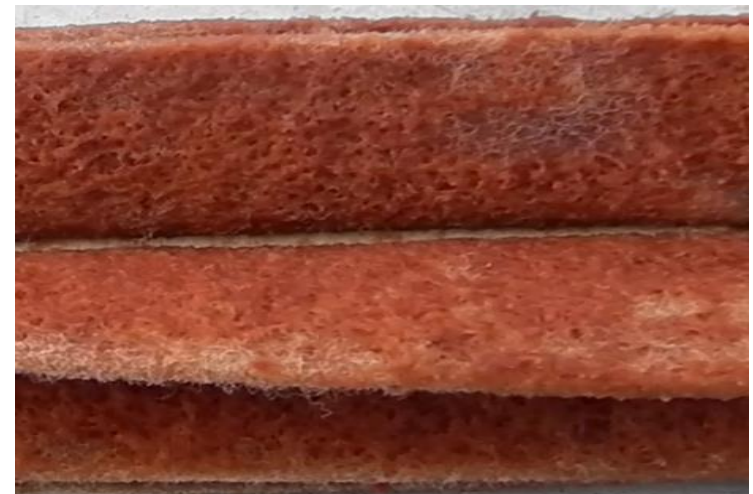
アナモックス槽内のアナモックス細菌が付着した担体
