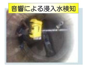
建設技術研究所、産業技術総合研究所、 熊本市等の共同研究体で、AIによる 音響データを用いた雨天時侵入水 検知技術(B-DASHプロジェクト)の 実証事業に取り組んでいます。
