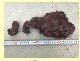
○点検の結果、燃え残りが発生した原因としては、計量コンベアの 異常による炉内への過剰投入が原因として推定した。計量コンベアの 点検・整備を実施し、再立ち上げ後は流動状況が改善している。 21
