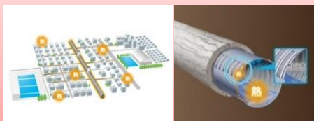
管更生と熱回収の同時施工
