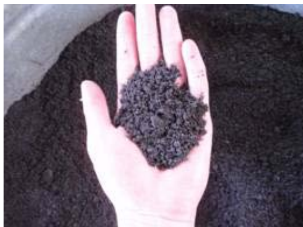
本技術脱水汚泥
